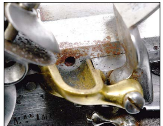
Gros plan sur le bassinet et son auget. Noter l'importance de la lumière du canon.
