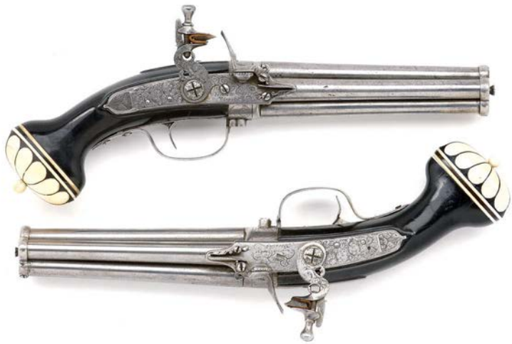
Une paire de pistolets à quatre canons, dont le bassinet est relié au mécanisme de tir. Fabriqués par Cornelis Coster, Utrecht, vers 1660.
