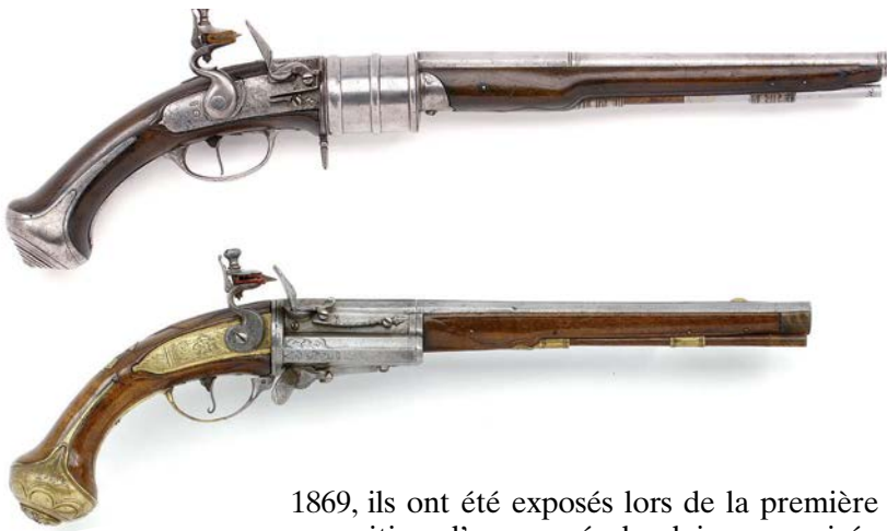
Un revolver à pierre à feu équipé de trois chambres, fabriqué en 1710-1720
