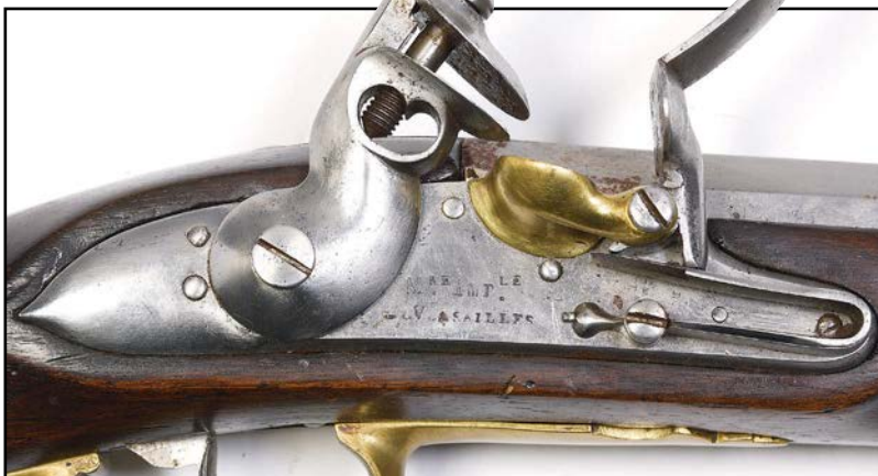
Gros plan sur la platine et ses marquages. Noter les dispositions résolument AN IX / XIII du chien, du bassinet et de la batterie.
