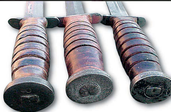
2 - Variantes de fixations du second type. Le poinçon, en forme de grenade du service du matériel (« ordonnance bomb »), témoigne que le poignard a satisfait au contrôle effectué lors de sa livraison à l'armée américaine.
