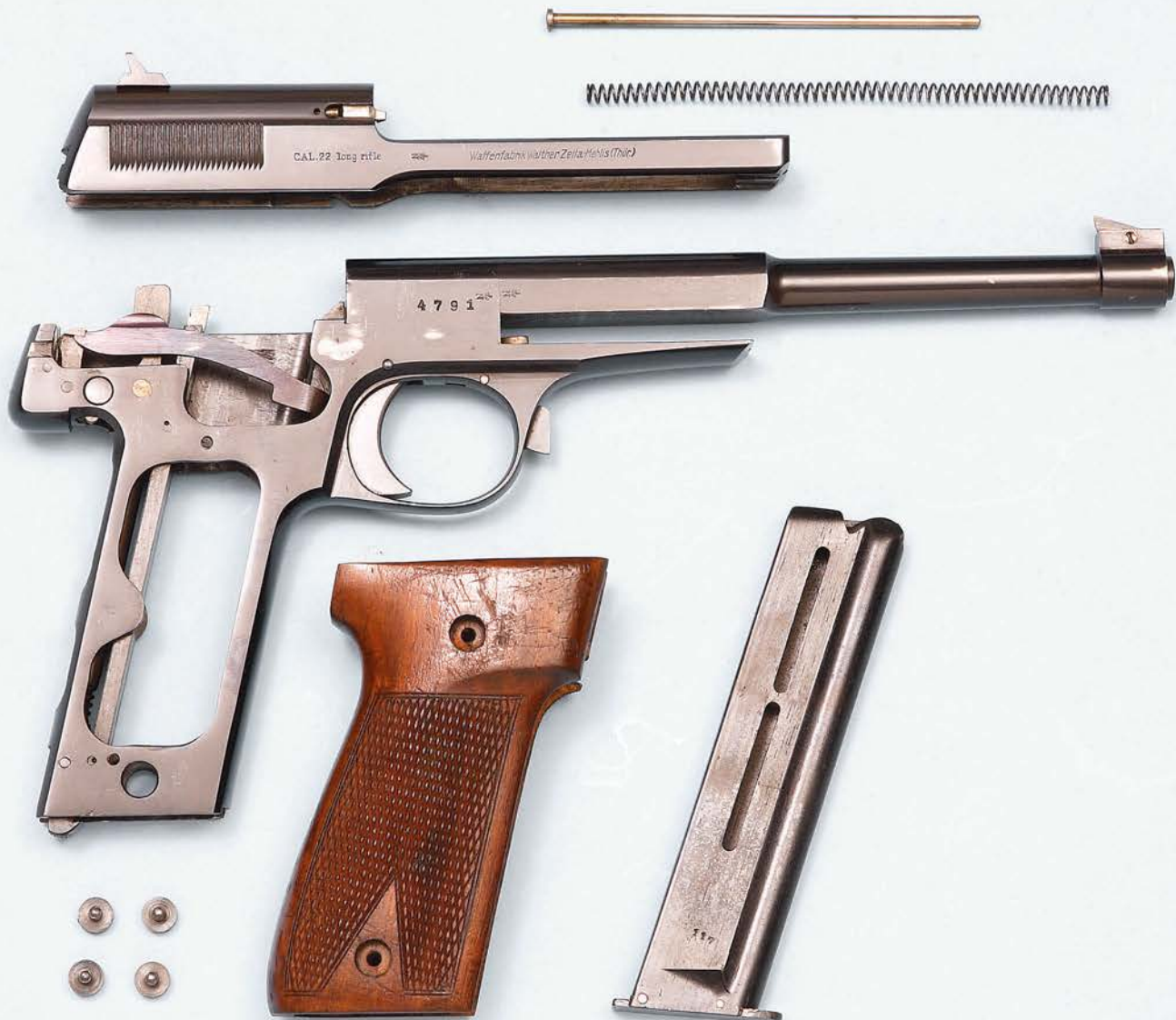
Walther 1932 partiellement démonté avec ses contrepois, son outil de réglage et son chargeur.
