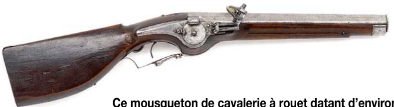
Ce mousqueton de cavalerie à rouet datant d'environ 1640-1650 possède quatre canons et peut tirer 19 coups grâce aux canaux d'allumage intérieurs qui relient les charges entre elles.
