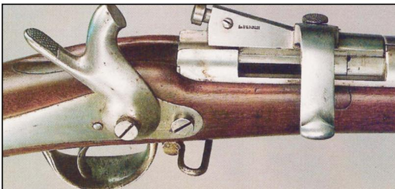
La transformation Perrin. Système à verrou logé dans le canon avec tête de culasse, extracteur et éjecteur. Très belle réalisation trop onéreuse.
