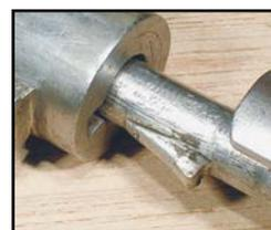
**Assemblage du percuteur dans la culasse. L'ergot triangulaire, poussé par le ressort, freine la rotation de la culasse et empêche l'ouverture si l'on secoue l'arme.**
