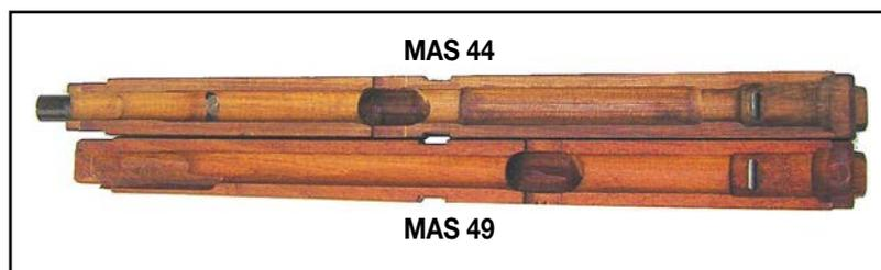
Comparaison entre les aménagements internes d'un fût de MAS modèle 44 et de MAS modèle 49.
