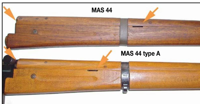
Comparaison des emplacements respectifs des orifices de refroidissement sur le fût d'un MAS 44 et d'un MAS 44 type A. La position de cet orifice en arrière de la grenadière, qui apparaît sur le MAS 44 type A sera conservée sur le MAS 49.
