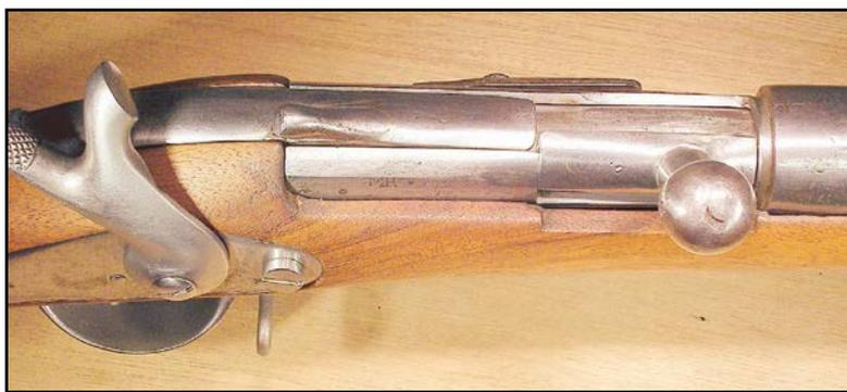
Vue de la position des pièces avant le tir et du système de sécurité. Le percuteur ne peut avancer, bloqué par le tenon du levier de manœuvre. Quand le levier est complètement abaissé, la percussion est possible. Le percuteur verrouille la culasse en position fermeture.
