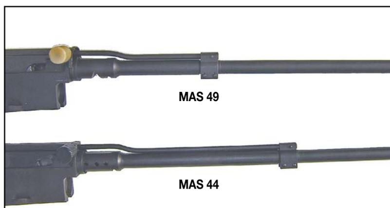
Comparaison entre les tubes adducteurs des gaz et les positions des événements des FSA MAS modèles 44 et 49.
