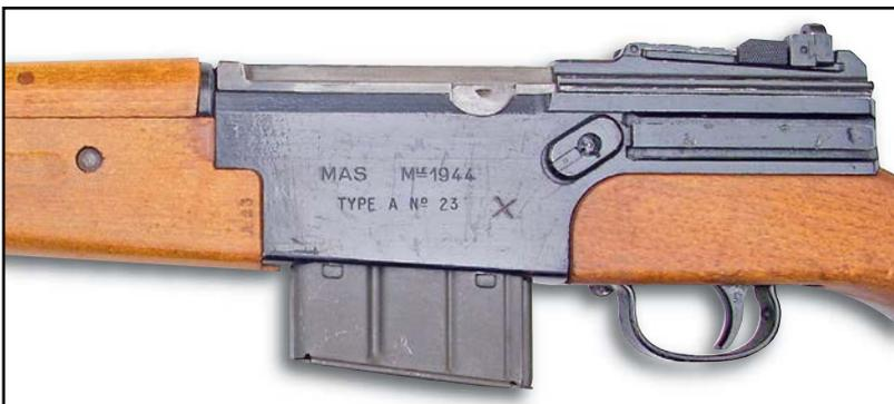
Face gauche du boîtier d'un MAS 44 type A, portant le numéro de série 23 A. La hausse réglable en hauteur et en dérive est celle qui sera adoptée pour le MAS 49. Par contre, le boîtier est un boîtier de MAS 44 A modifié, comme en témoignent les bords arrondis du coin d'appui de l'éjecteur et les traces sur le rail de fixation de lunette, laissant penser que ce dernier a été rapporté sur un boîtier de MAS 44 et non usiné dans la masse, comme ce sera plus tard le cas pour les MAS 49 et 49-56.
