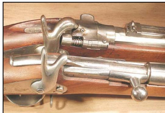
Comparaison entre le tabatière au second plan et le Paliard. Pour ce dernier l'encombrement de la culasse a fait avancer le tonnerre renforcé par une bague frettée.
