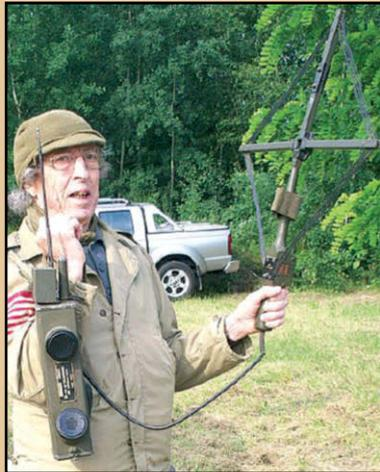
**Le SCR 536. Sa mise au point et sa production sont identiques au SCR 511. En 1945 plus de 130 000 exemplaires seront fabriqués. Ce Handy-Talkie conçu pour être tenu à la main, est composé des éléments suivants :**
