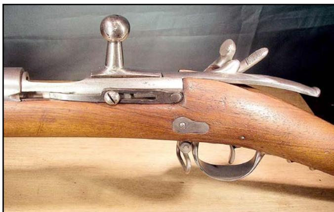
Vue de l'extracteur retenu par une vis. On voit nettement l'allonge du percuteur dépassant largement à l'arrière.
