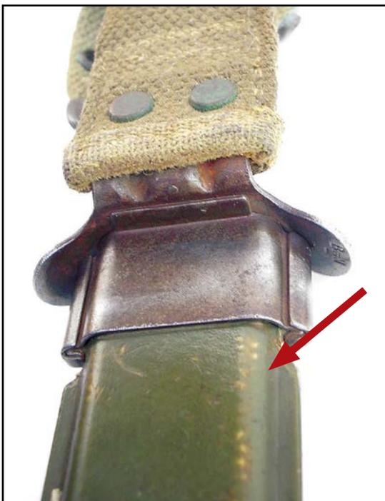
L'usure due au frottement (flèche) permet d'apercevoir sur cet étui M8 de fabrication BMCo la trame de la fibre enduite de résine qui constitue le corps du fourreau. Cette particularité, qui se retrouve également sur le fourreau réalisés dans la même matière pendant la seconde guerre mondiale pour les baïonnettes U.S. disparaîtra sur les fabrications des années 60, réalisées en plastique moulé.
