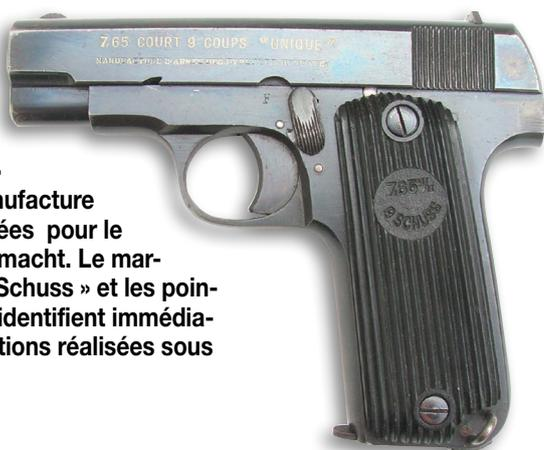
Pistolet Unique 17 « Kriegsmodell » fabriqué par la manufacture d'armes des Pyrénées pour le compte de la Wehrmacht. Le marquage « 7,65mm 9 Schuss » et les poinçons du Waffenamt identifient immédiatement ces productions réalisées sous l'occupation.
