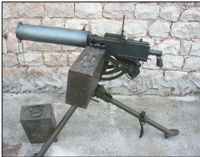
La mitrailleuse modèle 1917A1 sur son trépied. L'arme est ici alimentée par une bande en toile logée dans une caissette en bois qui se fixe du côté gauche de l'affût. (Photo : Georges Delporte)
