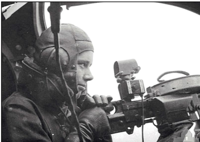
La mitrailleuse à refroidissement Vickers K gun, utilisée au début de la guerre comme mitrailleuse d'aviation, se trouva rapidement dépassée du fait des progrès faits par les armements de bord au cours du conflit. Les K guns déclassées par la RAF furent récupérées par les commandos SAS pour lesquels la grande cadence de tir de ces armes était intéressante pour en équiper leurs Jeep. (D.R.)
