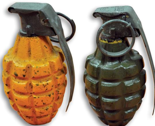
Grenade MK II : modèle d'avant 1942, peinte en jaune pour indiquer qu'il s'agit d'une grenade de combat (jaune = HE ou High Explosive) ; à droite un modèle MK II A1 postérieur à 1942, peint en vert olive avec une collerette jaune qui indique un chargement HE.
