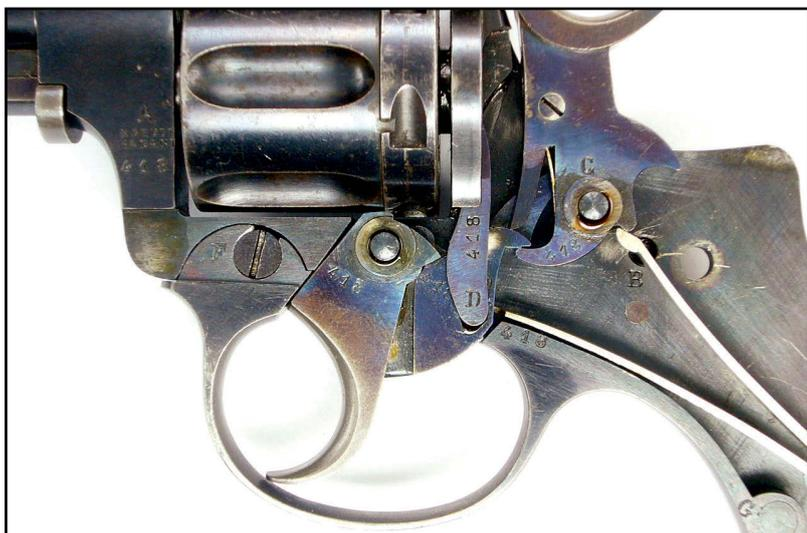
M.1887 avec détente en 2 pièces, brevet Tor F. Törnell (collection H. Harder).
