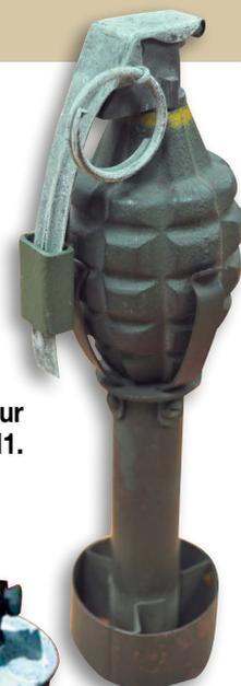
Grenade MK II fixée sur un adaptateur M1.
