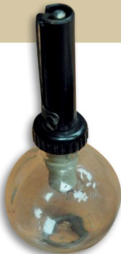
laquelle est vissé un manche en ébonite contenant le dispositif de mise à feu. La sécurité de transport est assurée par deux demi coques métalliques qui protègent la sphère de verre et qui sont maintenues en place par une goupille.
