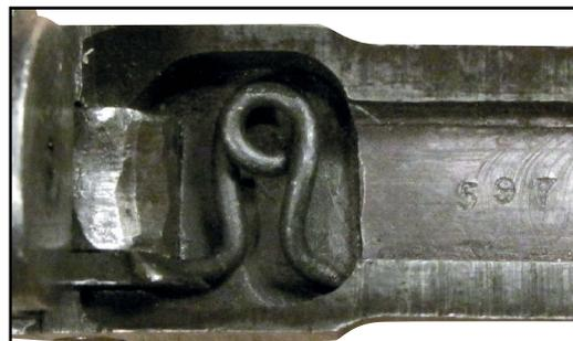
cher le chien d'atteindre le percuteur si le bloc-culasse n'est pas complètement en place et de verrouiller l'arrière du bloc en même temps qu'il percute la cartouche.
