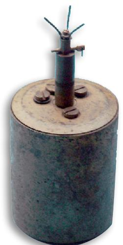
Mine S.MI 35 équipé d'un allumeur à pression S.MI.Z 35.
