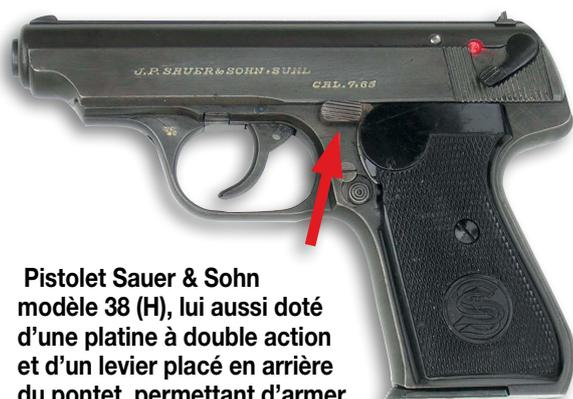
Pistolet Sauer & Sohn modèle 38 (H), lui aussi doté d'une platine à double action et d'un levier placé en arrière du pontet, permettant d'armer ou de désarmer le chien interne à l'aide du pouce de la main droite. Ces pistolets furent utilisés par la police (comme cet exemplaire, portant à l'avant du pontet le poinçon d'acceptation de la police « Aigle/c ») mais aussi par la Kriegsmarine.
