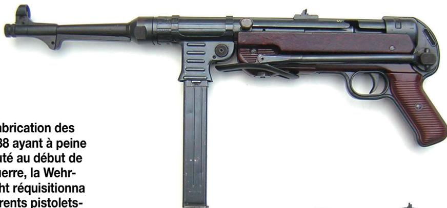
Le MP 40 est analogue au MP 38 si ce n'est que beaucoup de pièces usinées sur le MP 38 sont réalisées en acier embouti, replié et soudé sur le MP 40. Cet exemplaire, fabriqué par Erma (code ayf) en 1942 est monté avec des garnitures en bakélite rouge vif assez peu courantes.
