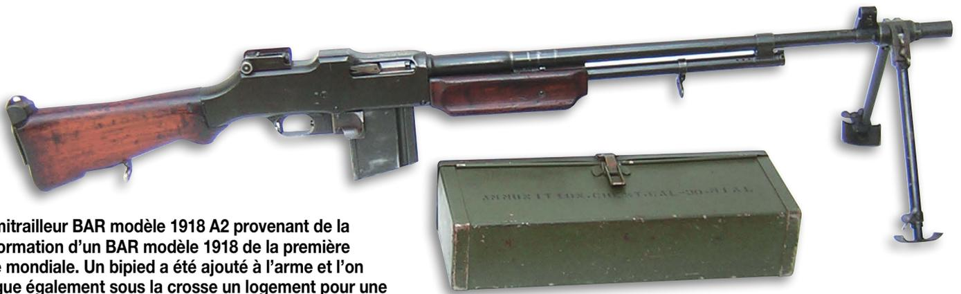
Fusil mitrailleur BAR modèle 1918 A2 provenant de la transformation d'un BAR modèle 1918 de la première guerre mondiale. Un bipied a été ajouté à l'arme et l'on distingue également sous la crosse un logement pour une béquille qui ne fut finalement pas retenue pour le service. Une caisse métallique pour le transport des chargeurs est posée devant l'arme.
