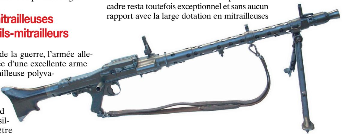
Composée d'un grand nombre de pièces réalisées par emboutissage, la MG 42 était rapide et peu coûteuse à fabriquer. Elle était également plus simple à servir que la MG 34, ce qui permettait de raccourcir le temps de formation des mitrailleurs. Sa cadence de tir extrêmement rapide (1200 coups par minute) entraînait parfois des difficultés de ravitaillement en munitions.
